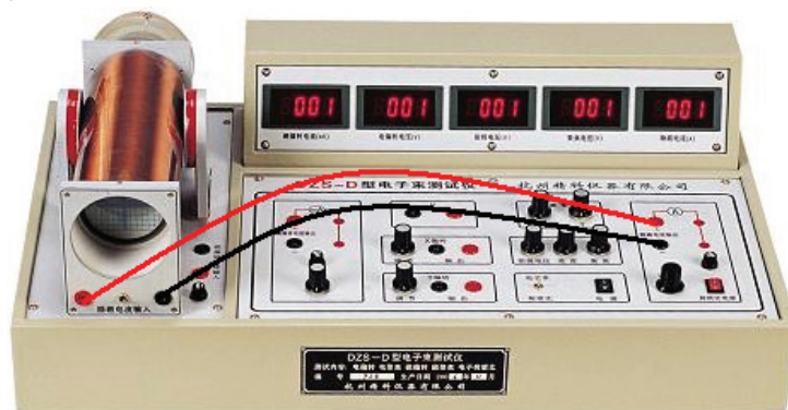
图 8 磁聚焦(荷质比测定)接线示意图
